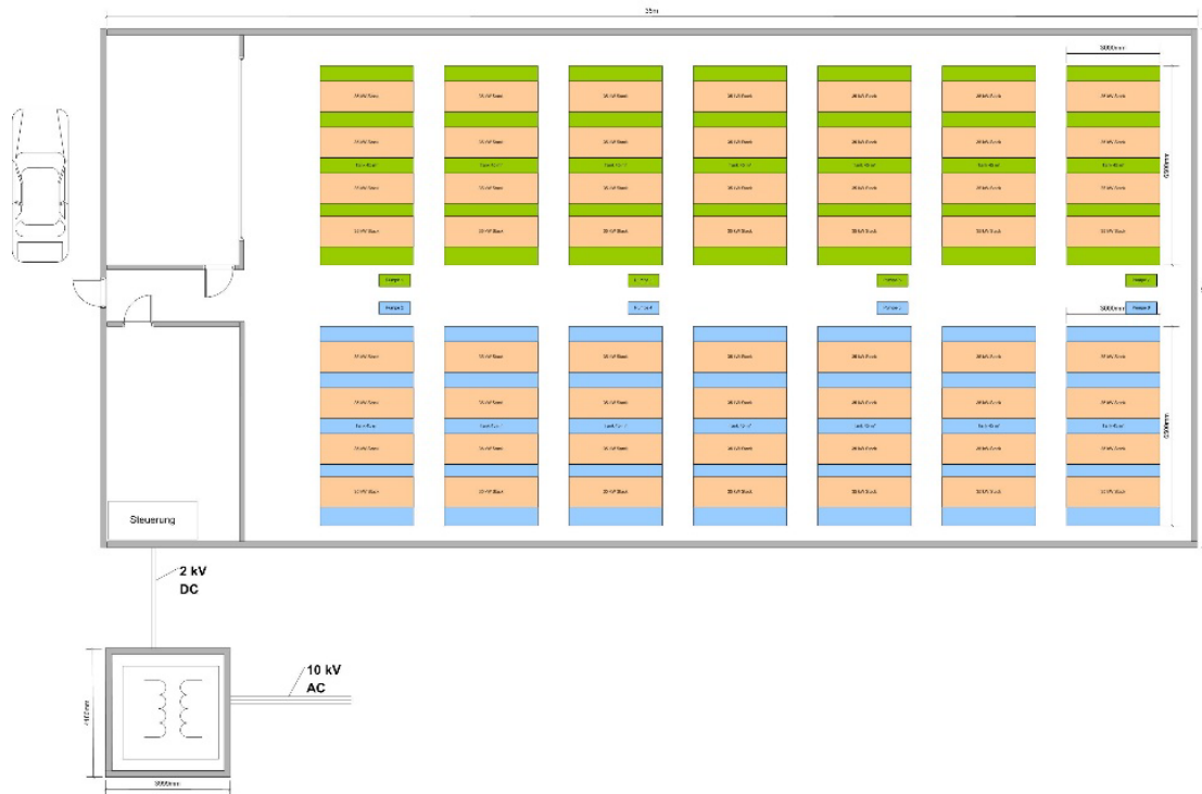
Flächenbedarf – Vanadium Redox Flow Batterie 2 MW, 20 MWh
